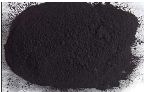
Bild 1. Aktivkohlepulver, hochporös, mit riesiger innerer und äußerer Oberfläche zur Absorption organischer Schadstoffe
